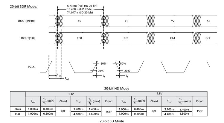
1.8V 3.3V t<sub>r</sub> (min) t<sub>r</sub> (max) t<sub>r</sub> (min)  $\mathsf{t}_{\mathsf{oh}}$  $\mathsf{t}_{\mathsf{oh}}$ Cload  $\mathsf{t}_{\mathsf{od}}$ (max) Cload Cload  $t_{od}$ Cload  $t_f$ t<sub>f</sub> t<sub>f</sub> t<sub>f</sub> 1.400ns dbus 38.000ns 0.400ns 41.000ns 1.400ns 38.000ns 0.400ns 41.000ns 15pF 15pF 38.000ns 0.500ns 41.000ns 1.600ns 38.000ns 0.400ns 41.000ns 1.500ns stat
